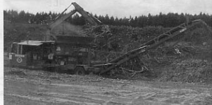
移動式破砕機による伐採現場での破砕
